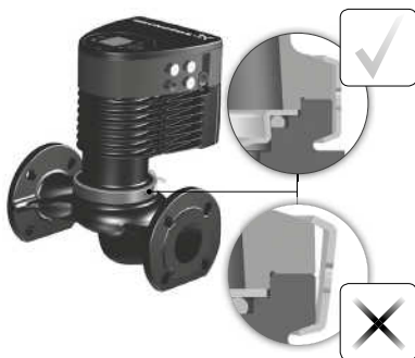
Рис. 17 Закрепление головной части насоса на корпусе
