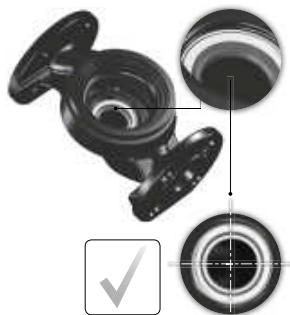
Рис. 15 Правильно выровненная система уплотнений
