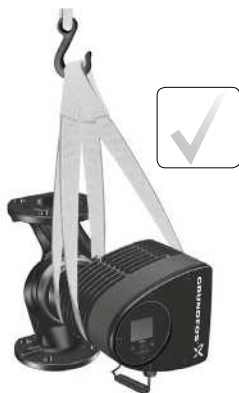
Рис. 8 Правильный способ строповки насоса
