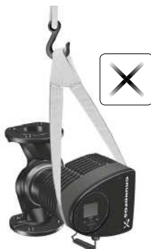
Рис. 9 Неправильный способ строповки насоса
