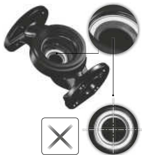
Рис. 16 Неправильно выровненная система уплотнений
