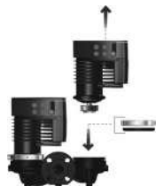
Рис. 37 Установка глухого фланца
