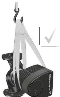
Рис. 9 Правильный способ строповки насоса
