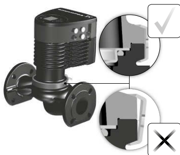
Рис. 18 Закрепление головной части насоса на корпусе насоса
