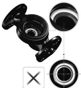
Рис. 17 Неправильно выровненная система уплотнений
