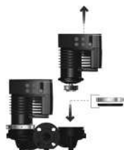
Рис. 37 Установка глухого фланца
