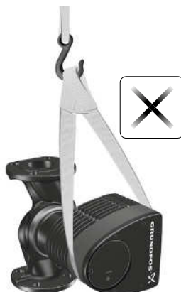
Рис. 10 Неправильный способ строповки насоса
