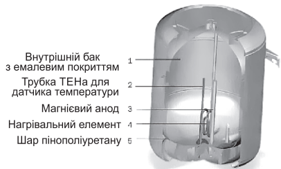
Рис.1. ЕВАД Classic в розрізі та його складові частини
