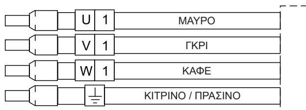
Αναγνώριση αγωγών καλωδίου ηλεκτρικών αντλιών
