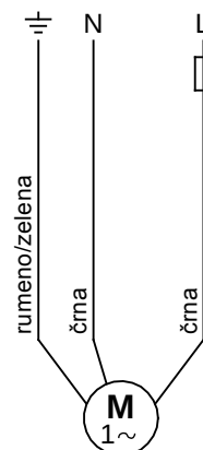
Slika 11 Motorji dvožilne izvedbe
